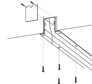
4 Закрепите корпус с помощью саморезов. Проденьте кабель питания в отверстие на торцевой заглушке.
