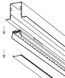
1 Снимите из пазов светильника рассеиватель и монтажную пластину
