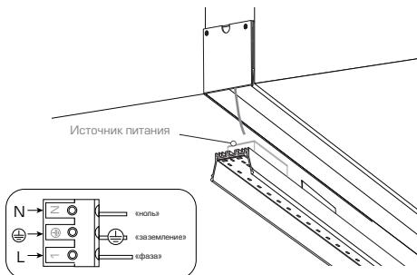
6 Подключите кабель питания к клемной колодке на монтажной пластине в соответствии с маркировкой
