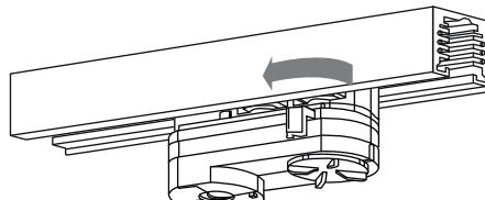
**ВНИМАНИЕ.** Все работы по монтажу шинопровода и установке светильников, замене ламп и техническому обслуживанию следует проводить при отключенном напряжении питания шинопровода.
